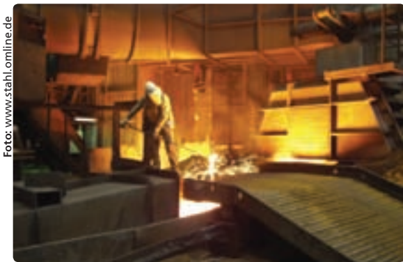
► La producción de acero antiabrazión se desarrolla en hornos de arco eléctrico y fundición de colada continua.
